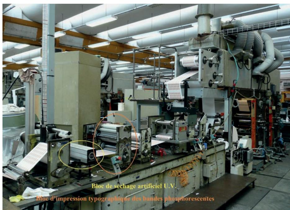
Figure 13 : presse taille-douce six couleurs. (source : Documentation interne ITVF).
